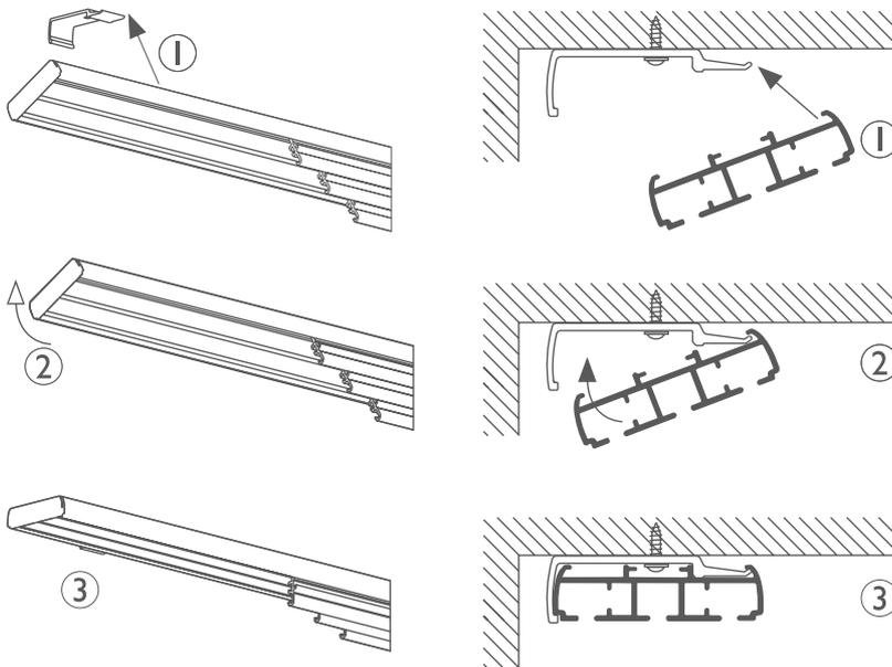
Wählen Sie je nach Beschaffenheit der Decke, dass richtige Montagezubehör. Den ersten und den letzten Clip 5-10 cm vom Schienenende montieren, weitere Clips aufteilen. Alle Clips festschrauben. Schiene schräg, vorn auf die Clips setzen (1) Schiene nach oben drücken (2) bis sie hörbar einrastet (3).
