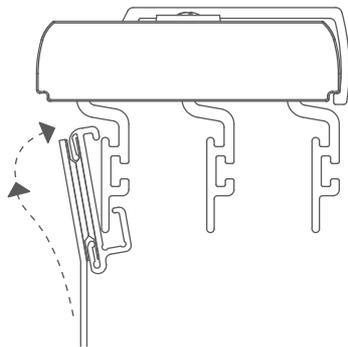
Das Klett-Oberprofil wird mit dem Behang einfach in den Gleitwagen gehängt.
