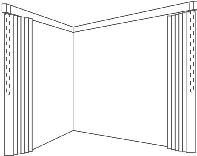
Erkeranlagen sollten vorzugsweise aus zwei einteiligen Anlagen gefertigt werden. Behang und Bedienung sollten dabei vorzugsweise an der Außenseite sein.
