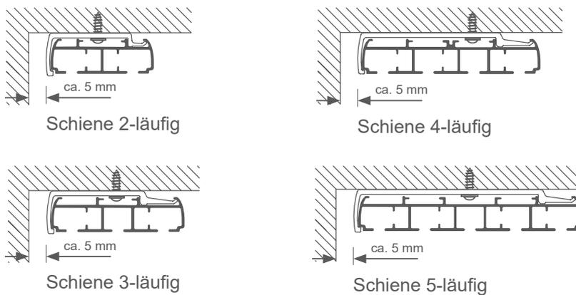
Die Schiene kann dicht an der Wand befestigt werden. Um sie wieder aus den Trägern zu lösen, sollte der Wandabstand ca. 5 mm betragen. Die folgenden Zeichnungen zeigen den Querschnitt der Schienen mit Clip und Schraube.
