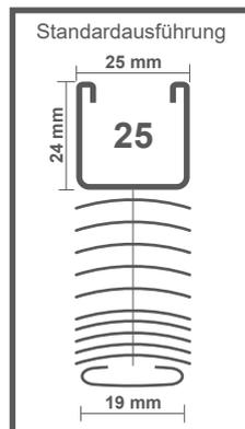
**Oberschiene:** U-Profil aus Stahl, Breite 25 mm, Höhe 24 mm, mit abgerundeten Kanten, 0,50 mm stark, einbrennlackiert. Farbton auf die Lamellen abgestimmt. Endkappen innenliegend aus Kunststoff, transparent. Siehe Farbkarten.
