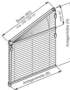
Freihängende Slopeanlage mit Schnurzugbedienung oben und unten. Unterer und dreieckiger Behang mit Rastfunktion.
