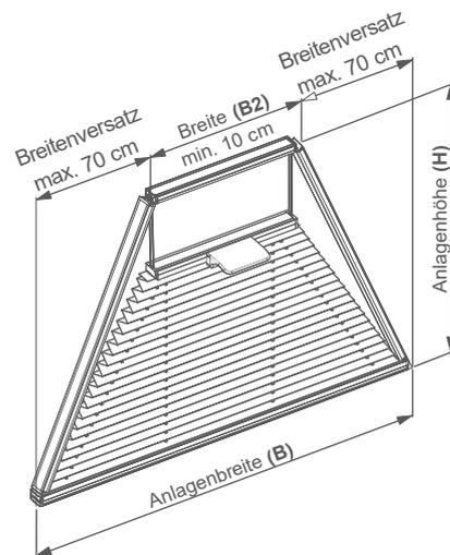
Gespannte Anlage mit Bediengriff und beidseitig schrägem Behang.
