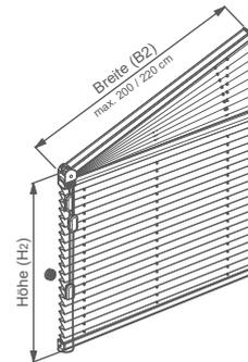
Freihängende Slopeanlage mit Schnurzugbedienung unten. Unterer Behang mit Rastfunktion und dreieckiger ohne Rastfunktion.
