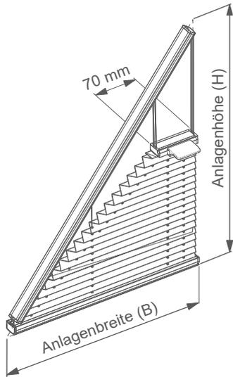
Gespannte Anlage mit Bediengriff und einseitigem schrägem Behang.
