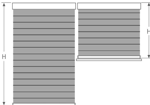
Beim Erreichen der Bestellhöhe, ist jede Anlage geschlossen. Die Gewebestreifen sind **nicht** höhengleich positioniert.
