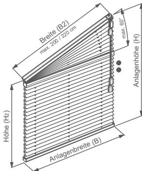
Freihängende Slopeanlage mit Schnurzugbedienung oben. Unterer und dreieckiger Behang ohne Rastfunktion.
