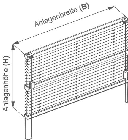
Freihängende Anlage mit zwei Schnurzugbedienungen und zwei Behängen.
