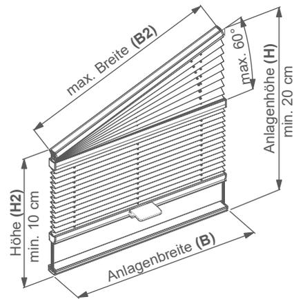
Gespannte Slopeanlage mit Bediengriff und Spannschiene.
