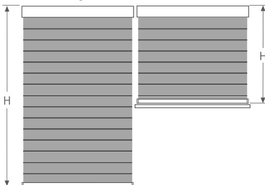
Beim Erreichen der Bestellhöhe, ist jede Anlage geschlossen. Die Gewebestreifen sind höhengleich positioniert. Die Position der Unterleiste ist abhängig von der Behanglänge und wird unterschiedlich im Behang positioniert.
