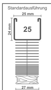
**Oberschiene:** U-Profil aus Stahl, Breite 25 mm, Höhe 24 mm, mit abgerundeten Kanten, 0,50 mm stark, einbrennlackiert. Farbton auf die Lamellen abgestimmt. Endkappen innenliegend aus Kunststoff, transparent. Mit passender Holzblende und Magnetbefestigung. Siehe Farbkarten.
