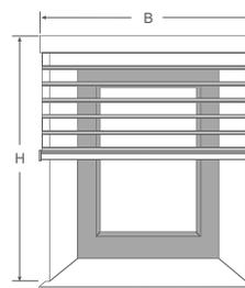
B = Anlagebreite einschließlich gewünschtem Überstand. Wir empfehlen mind. + 100 mm
