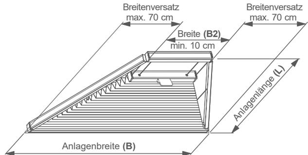
Gespannte Anlage mit Bediengriff, Oberschiene, Drahtspannung und einseitig schrägem Behang.
