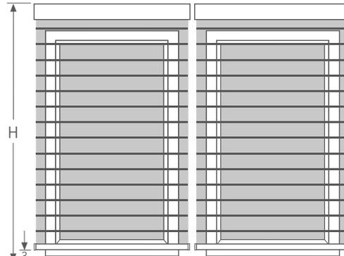
Beim Weiterziehen wird der Behang geöffnet, die Unterleiste ca. 30 mm angehoben. Im geöffneten Zustand, sind die Gewebestreifen höhengleich positioniert.
