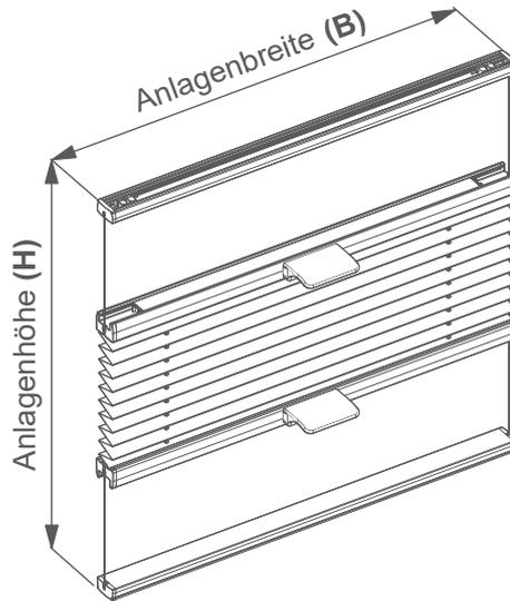
Gespannte Anlage mit Bediengriff, variablem Behang und Spanschiene, oben und unten.
