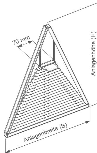
Gespannte Anlage mit Bediengriff und beidseitig schrägem Behang.
