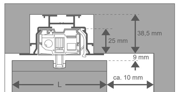
Montage mit Sonderzubehör Einbauprofil. (Schienenbefestigung mit Kunststoffclip.)
