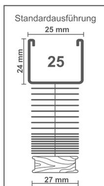
**Oberschiene:** U-Profil aus Stahl, Breite 25 mm, Höhe 24 mm, mit abgerundeten Kanten, 0,40 mm stark, einbrennlackiert. Farbton auf die Lamellen abgestimmt. Endkappen innenliegend aus Kunststoff, transparent. Mit passender Holzblende und Magnetbefestigung. Siehe Farbkarten.
