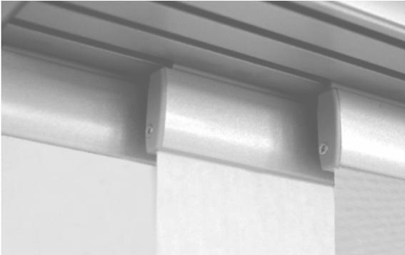
Gleitwagen mit Rollen aus hochwertigem Kunststoff. Ober und Unterprofil aus stranggepresstem Aluminium, in weiß pulverbeschichtet oder silber. Der Stoff wird einfach mit Hilfe eines Keders in den Profilen befestigt.
