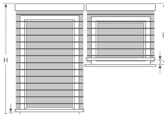
Beim Weiterziehen wird der Behang geöffnet, die Unterleiste ca. 30 mm angehoben. Im geöffneten Zustand, sind die Gewebestreifen höhengleich positioniert.
