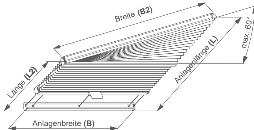
Gespannte Slopeanlage mit Bediengriff und Drahtspannung.
