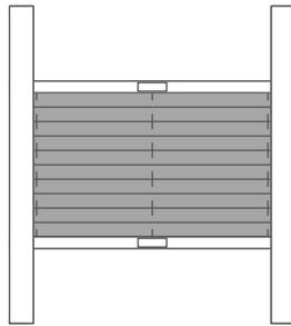
Gespannte Dachfenster-Anlage mit Bediengriffen, variablem Behang und zwei Seitenführungsschienen.
