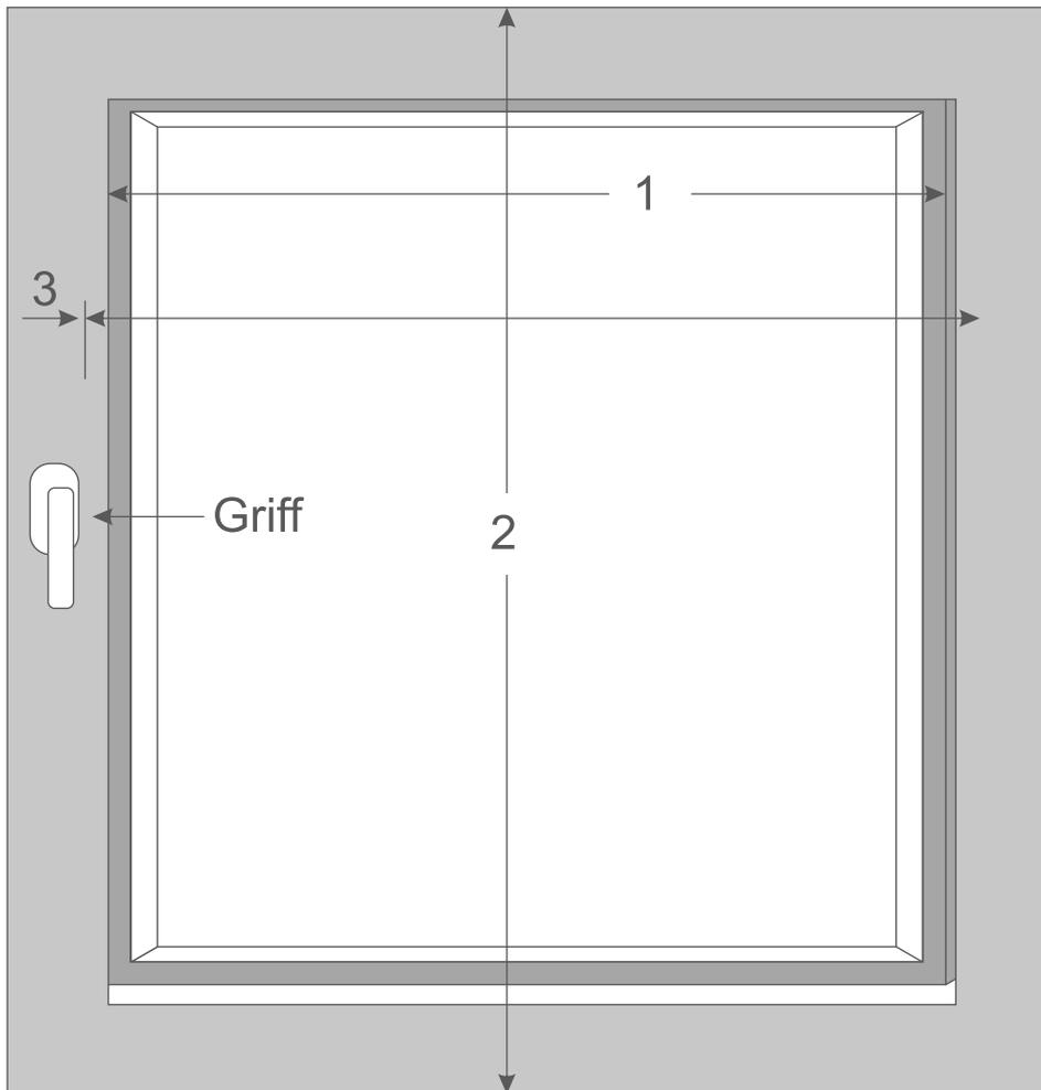
Optimale Breite Position 1, wenn die Jalousie bis zum Bediengriff gehen soll Position 3. Optimale Höhe Position 2 minus minimum 15 mm bei 25 mm Lamellen **ergibt das Fertigmaß**
