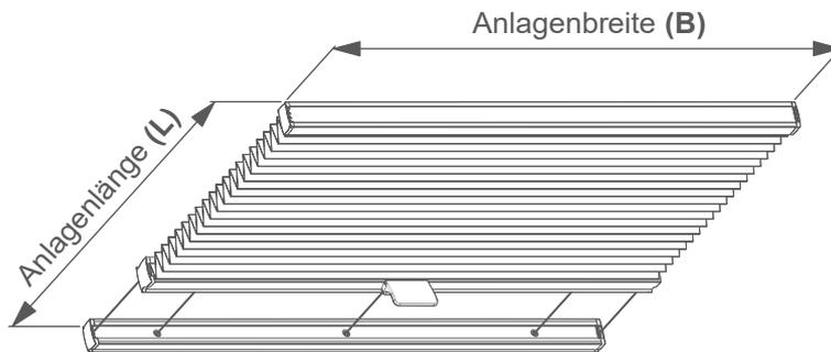
Gespannte Anlage mit Bediengriff, Unterschiene und Drahtspannung.
