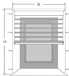
B = Anlagebreite = kleinste lichte Breite minus 10 mm\*
