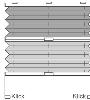
Gespannte Dachfenster-Anlage mit 2 Behängen oben (Tag-/Nacht-Variante) und Spanschieneverrastung.
