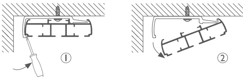
Um die Schiene zu demontieren, die Clips vorsichtig mit einem Schlitzschraubendreher aufdrücken (1) und die Schiene schräg herausnehmen (2).
