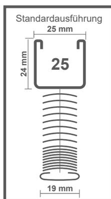
**Oberschiene 25:** U-Profil aus Stahl, Breite 25 mm, Höhe 24 mm, mit abgerundeten Kanten 0,50 mm stark, einbrennlackiert. Endkappen innenliegend aus Kunststoff, transparent. Farbton auf die Lamellen abgestimmt. Siehe Farbkarten.
