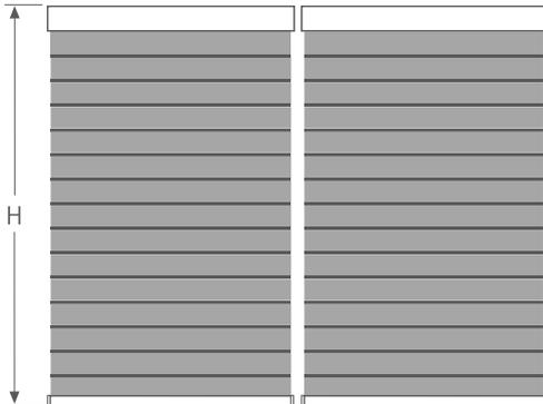
Beim Erreichen der Bestellhöhe, ist jede Anlage geschlossen. Die Gewebestreifen sind höhengleich positioniert.
