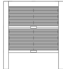
Gespannte Dachfenster-Anlage mit zusätzlichem Blendenprofil und 2 Behängen oben (Tag-/Nacht-Variante).
