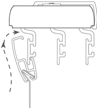
Das Keder-Oberprofil wird mit dem Behang einfach in den Gleitwagen gehängt.
