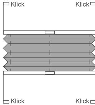
Gespannte Dachfenster-Anlage mit Bediengriffen und variablem Behang und Spanschieneverrastung.
