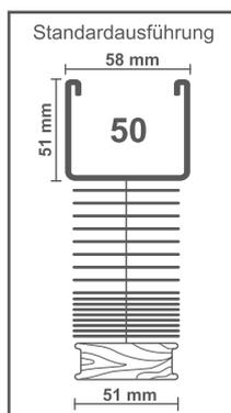
**Oberschiene 50:** U-Profil aus Stahl, Breite 58 mm, Höhe 51 mm, mit abgerundeten Kanten, 0,50 mm stark, einbrennlackiert. Mit passender Holzblende und Magnetbefestigung.
