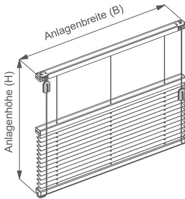
Freihängende Anlage mit zwei Schnurzugbedienungen und variablem Behang.
