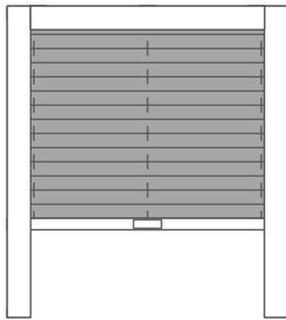
Gespannte Dachfenster-Anlage mit zusätzlichem Blendenprofil und Behang oben.
