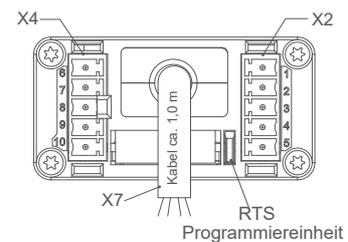
Das **Plafondmodul** dient der Verbindung zweier Antriebe bei einer Plafond-Anlage. Es wird je Antrieb einmal benötigt und ermöglicht den Datenaustausch und somit die Synchronisation zwischen den Steuerungen. Die Steuersignale ZU/AUF werden nur an einen Antrieb geführt!
