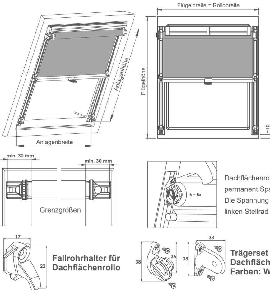
Dachflächenrollo mit permanent Spannung. Die Spannung ist am linken Stellrad einstellbar.
