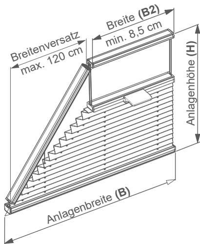
Gespannte Anlage mit Bediengriff und einseitigem schrägem Behang.
