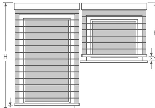
Beim Weiterziehen wird der Behang geöffnet, die Unterleiste ca. 30 mm angehoben. Im geöffneten Zustand, sind die Gewebestreifen **nicht** höhengleich positioniert.
